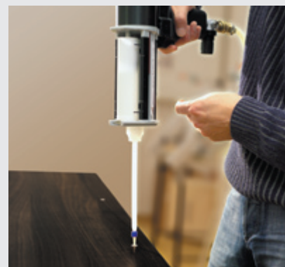
3. Подача клея с помощью сжатого воздуха
